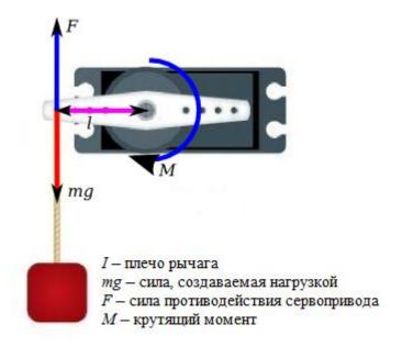
Эта характеристика показывает, насколько тяжёлый груз удержать сервопривод в покое на рычаге заданной длины. Если крутящий момент сервопривода равен  $5 \ H \times M$ , то это значит, что сервопривод удержит на весу в горизонтальном положении рычаг длины 1 м, на свободный конец которого подвесили груз весом P = 5H. Или, что эквивалентно, рычаг длины 5 м, к которому подвесили груз весом P = 1H.
