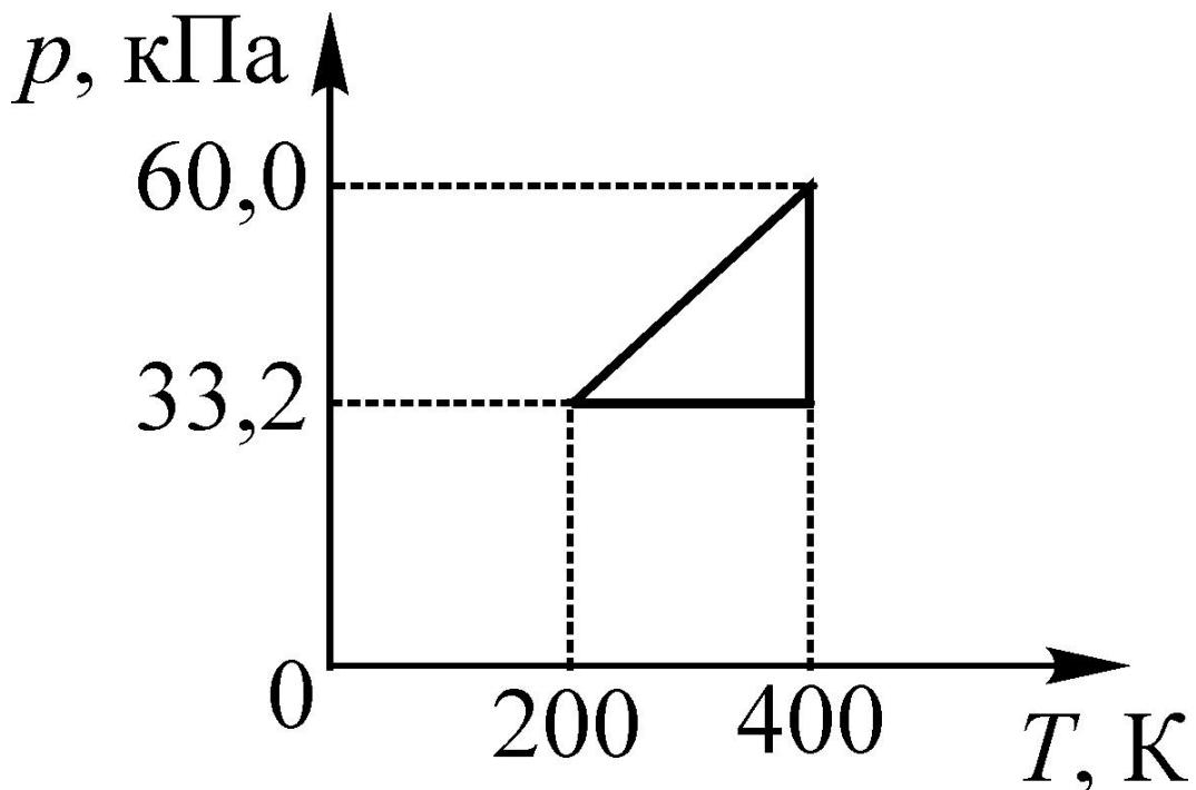
На  $pT$ -диаграмме изображён график процесса, проводимого со 100 молями идеального газа. Определите минимальный объём газа в этом процессе. Универсальную газовую постоянную принять равной  $R = 8,3 \text{ Дж}/(\text{моль} \cdot \text{К})$ . Ответ выразите в  $\text{м}^3$  и округлите до целых.
