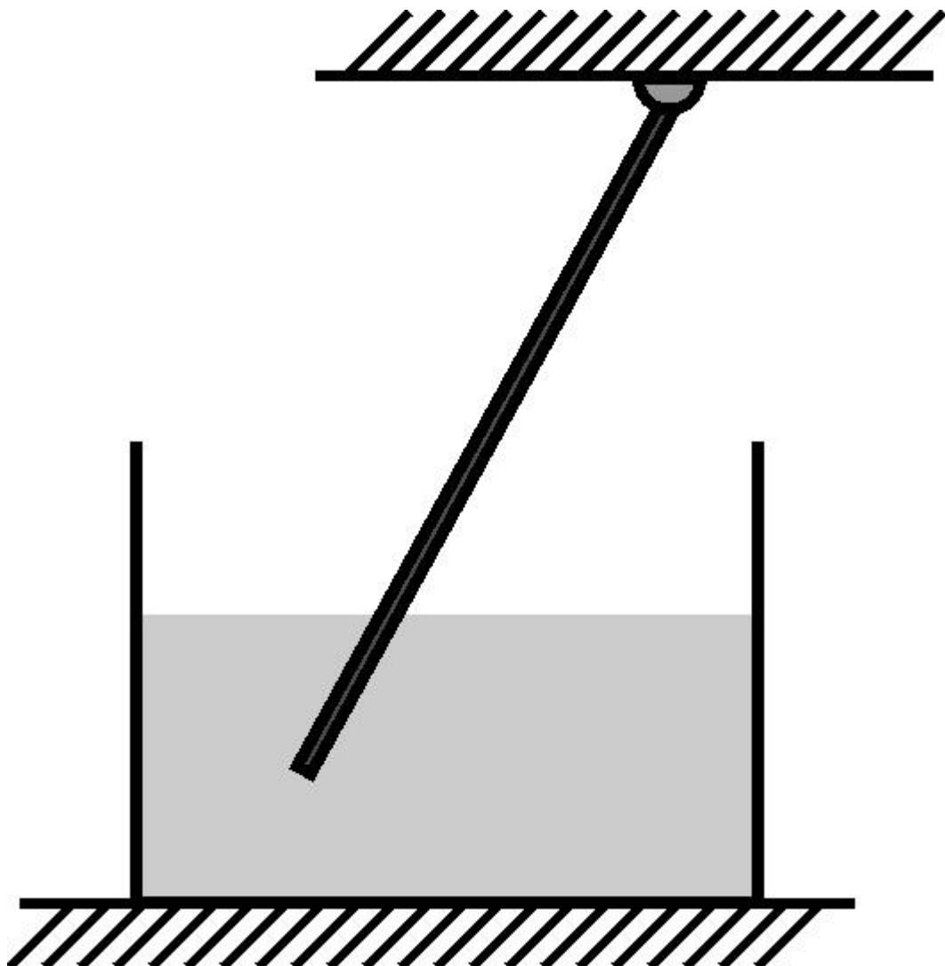
Один конец однородной палочки массой  $m = 300$  г и плотностью  $\rho = 0,75$  г/см<sup>3</sup> закреплен на шарнире, а другой погружен в жидкость плотностью  $\rho_0 = 1$  г/см<sup>3</sup>. Найдите силу, с которой палочка действует на шарнир в положении равновесия. Ускорение свободного падения принять равным  $g = 10$  м/с<sup>2</sup>. Ответ выразите в Ньютонах и округлите до целых.
