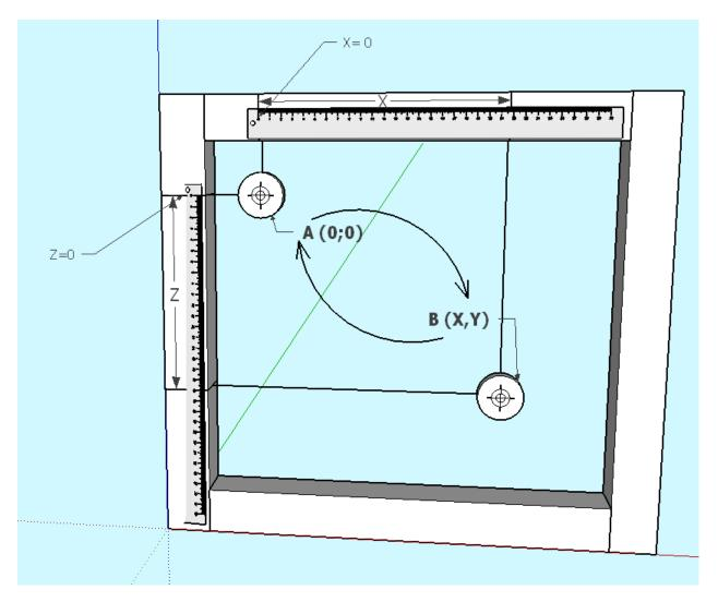
Манипулятор состоит из рамы, движущейся части — каретки и системы связи между кареткой и управляющими движением моторами. Моторы могут быть закреплены как на раме, так и на подвижной части.
