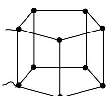
**Задача 5.** Определите эквивалентное сопротивление проволочной фигуры, показанной на рисунке, если сопротивление каждого проводника (вне зависимости от его длины) равно 38 Ом. Ответ выразите в Омах и округлите до целых. **10 баллов.**
