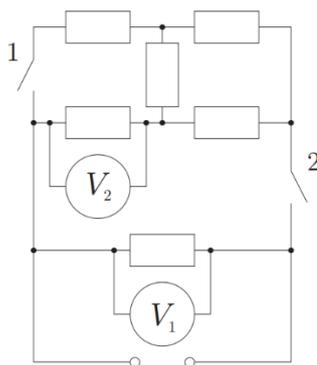
1) Какое напряжение показывает вольтметр  $V_1$ , когда замыкают только ключ  $1$ . Ответ выразите в В, округлите до целого числа. (2 балла)
