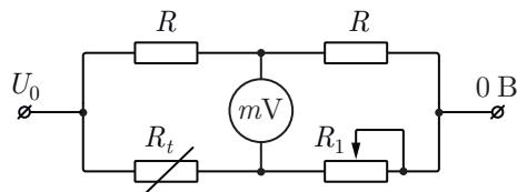
1) Для температуры  $T_0 = 50$  °С определите зависимость  $U(\Delta T)$ , считая изменение сопротивления терморезистора малым. В области каких температур (высоких или низких) измеритель обеспечивает меньшую относительную погрешность измерения? (7 баллов)
