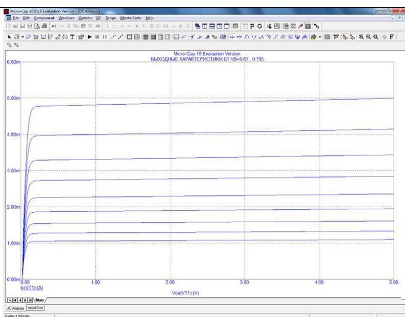
Для построения графика характеристики передачи тока базы необходимо, изменяя напряжение смещения, варьировать величину тока базы. Определение коэффициента усиления по току производится аналогично крутизне (по наклону графика)
