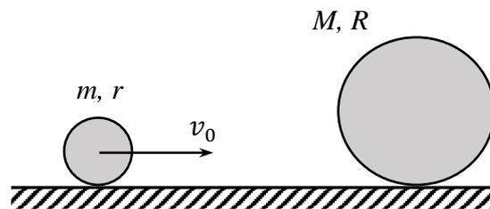
Определите скорость большого шара сразу после упругого удара. Считайте, что шар меньшего радиуса сначала соударяется с большим шаром, а после с поверхностью стола. Трения нет. Ответ выразите в м/с, округлите до целого числа.
