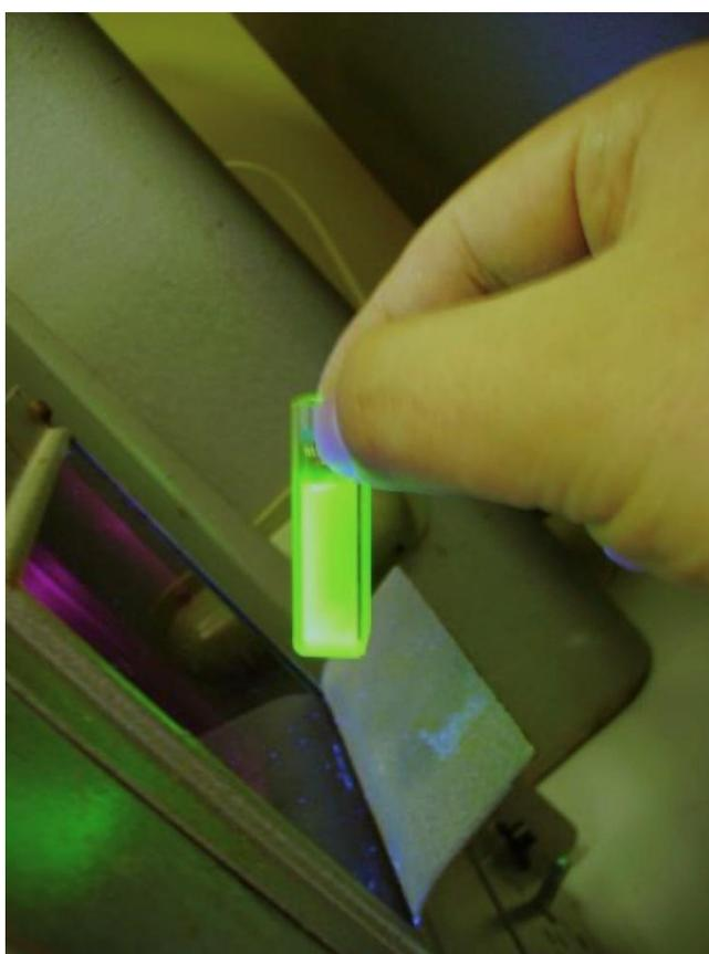
*Рисунок 1* – Яркая флуоресценция рибофлавина при облучении ультрафиолетом.
