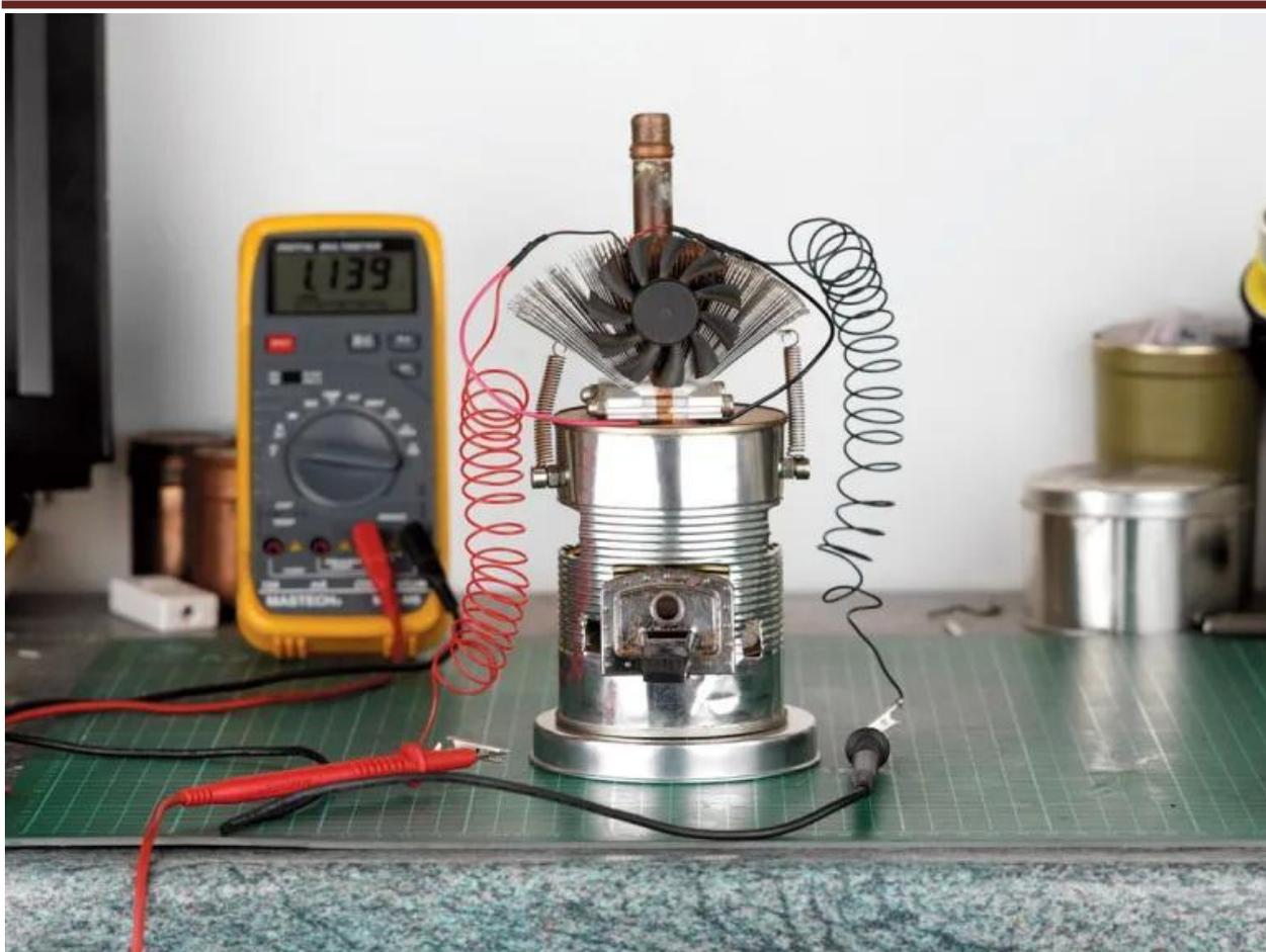
*Рисунок 2.* Термоэлектрический генератор усовершенствованной конструкции
