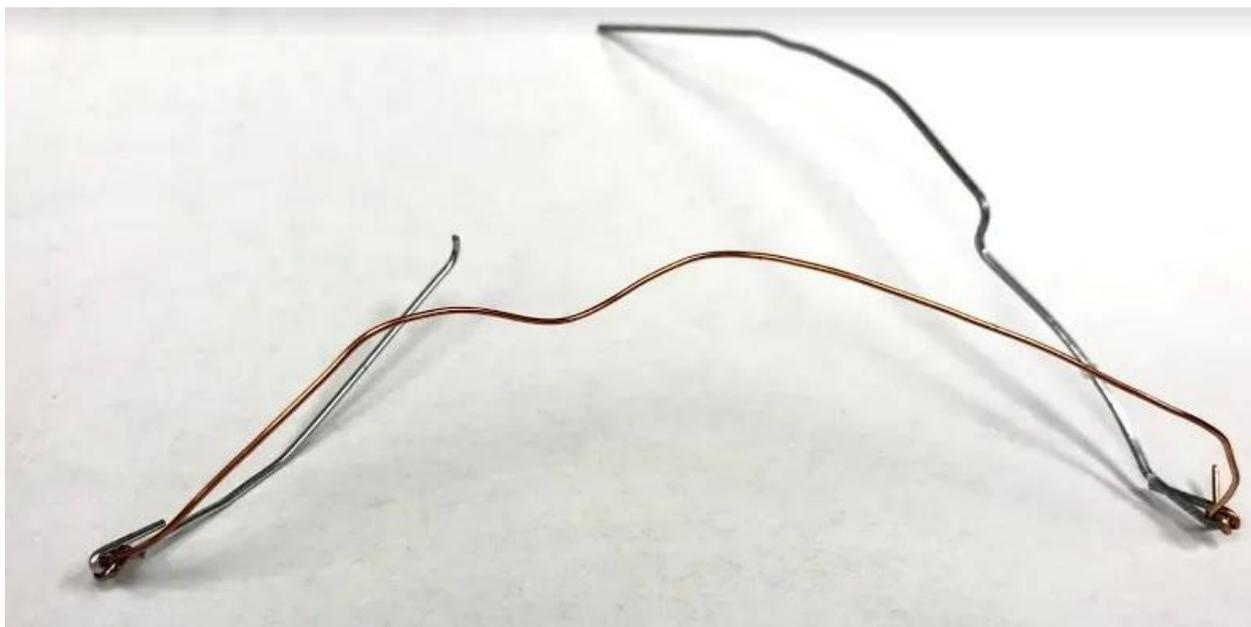
*Рисунок 1.* Пример конструкции простейшего термоэлектрического генератора
