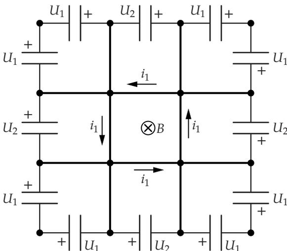
Напряжения на конденсаторах, располагающихся в угловых ячейках, одинаковы и равны  $U_1 = 2\mathcal{E}_0$ , поскольку сумма напряжений на этих конденсаторах должна быть равна (с точностью до знака) скорости изменения магнитного потока через ячейку. Сумма напряжений на всех конденсаторах должна быть равна абсолютной величине скорости изменения магнитного потока через все ячейки сетки.
