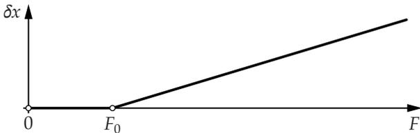
Далее в задаче рассматриваются однородные пружины, для любого участка которых постоянные  $F_0$  и  $\varepsilon$  такие же, как для исходной пружины длиной  $L_0$ . В каждом из пунктов масса пружины обозначается  $M$ . Коэффициентом упругости  $k$  поджатой пружины считается коэффициент пропорциональности между изменением силы и удлинением  $k = \frac{F(x)-F_0}{x}$  при  $F > F_0$ . Во всех пунктах задачи рассматривается статическое равновесие пружин.
