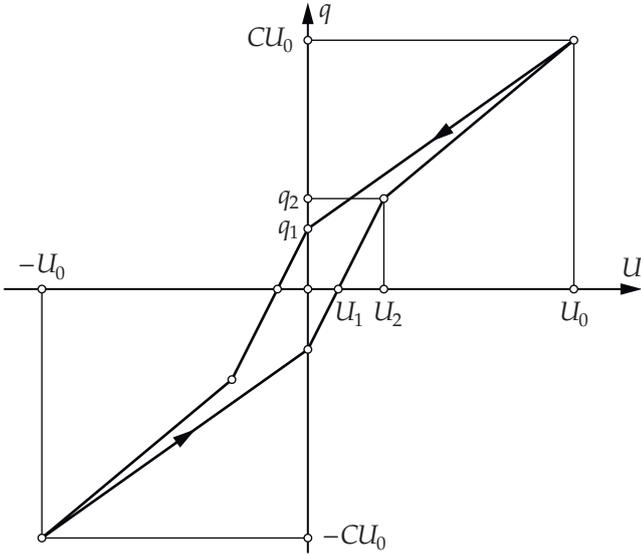
Параметры петли гистерезиса, обозначенные на графике, равны  $U_1 = 0,1U_0$ ,  $U_2 = 0,25U_0$ ,  $q_1 = 2CU_1$ ,  $q_2 = q_1 + 0,1CU_0$ . Значения  $U_0$  и  $C$  известны, при этом  $nRC \ll 1$ . Найдите среднюю за период мощность, потребляемую цепью от генератора и среднюю мощность, выделяющуюся на резисторе. Ответы выразите через параметры  $C$ ,  $U_0$ ,  $n$ .
