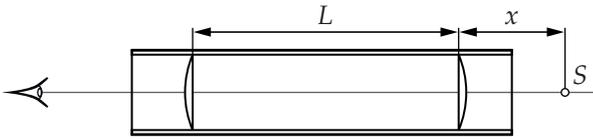
Наблюдатель рассматривает через систему линз небольшой предмет  $S$ , располагающийся на расстоянии  $x$  от передней линзы. График зависимости поперечного увеличения  $\Gamma$  от расстояния  $x$  показан на рисунке. Предполагая, что изображение формируется параксиальными (приосевыми) лучами, определите расстояние  $L$  между линзами, а также их фокусное расстояние  $f$ .
