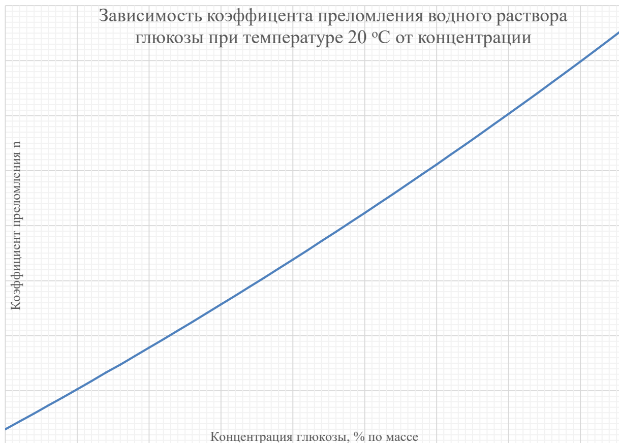
Рисунок 2 – Рефрактометрический градуировочный график.
