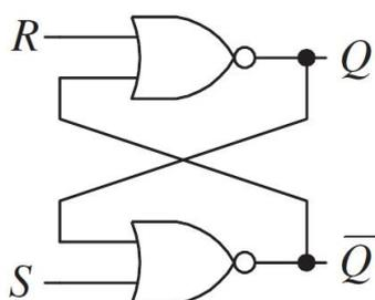
Для триггеров такого рода характерным является то, что его выходы  $Q$  и  $\bar{Q}$  при нормальном режиме работы находятся в противофазе, то есть если на одном из них значение «0», то на другом – «1» и наоборот.
